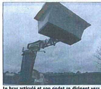
Le bras articulé et son godet se dirigent vers la benne sélectionnée.
